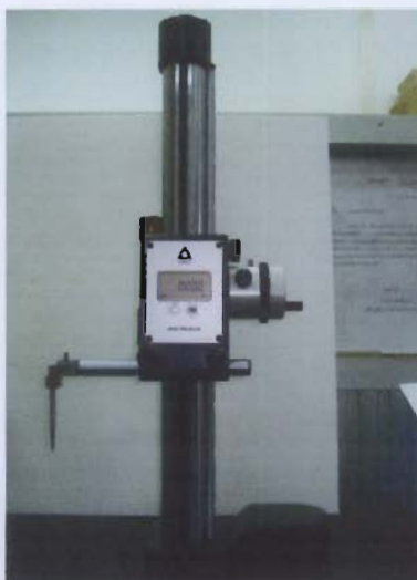
รูปที่ 4.3 แสดง Digital Hi – gauge สำหรับวัดระยะการเคลื่อนที่ของตัวตาม (follower)
