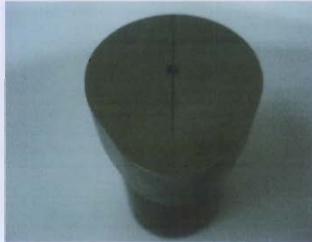
รูปที่ 4.1 ลูกเบี้ยวไอตีของเครื่องยนต์ Honda Accord EX 93
