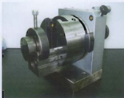
รูปที่ 4.5 ลักษณะการจับยึดลูกเบี้ยวกับชุด Punch Former Model
