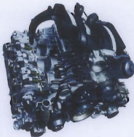
รูปที่ 2.3 รูปเครื่องยนต์สูบนอน 6 สูบ ของรถ พอร์ช (Porsche) 911
