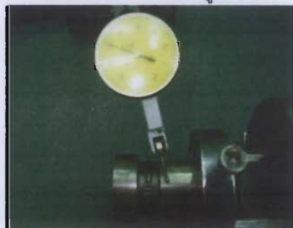
รูปที่ 4.6 แสดงการปรับตั้งศูนย์กลางของลูกเบี้ยวกับชุด Punch Former Model
