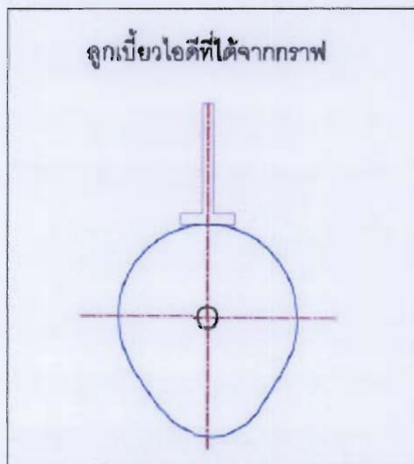
รูปที่ 4.16 ขนาดของลูกเบี้ยวไอดีที่ได้จากกราฟที่ Scale 1:1
