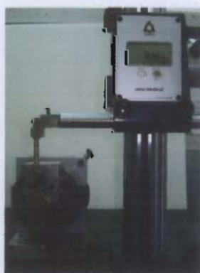
รูปที่ 4.7 ลักษณะการวัดลูกเบี้ยวด้วยแท่นหมุนองศาและขนาดโดยใช้ไฮเกจ
