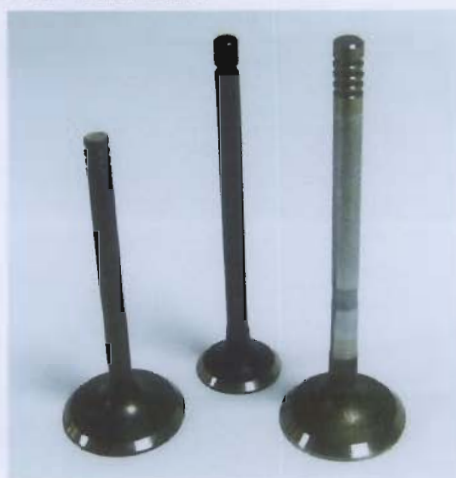
รูปที่ 2.7 แสดงชิ้นส่วนของวาล์วไอดี- ไอเสีย
