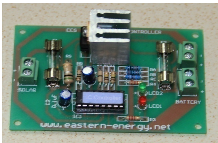
รูปที่ 3.8 วงจรควบคุมการชาร์จแบตเตอรี่ ที่มา http://www.eastern-energy.net/?lang=th
