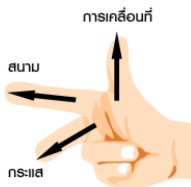
รูปที่ 2.17 กฎมือขวาของเฟลมมิง
