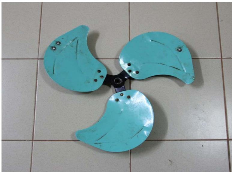
รูปที่ 3.14 ใบพัดแบบโลหะ มีการถ่วงสมดุลของใบพัดแล้ว
