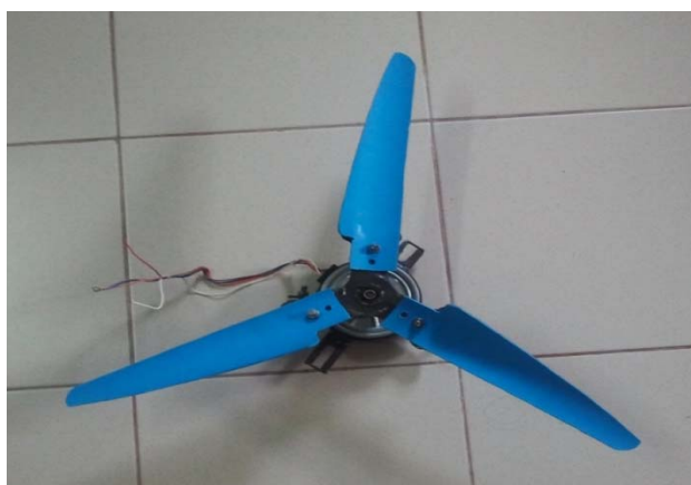
รูปที่ 3.12 ใบพัดที่ได้จากท่อ PVC ประกอบเข้ากับดุมใบพัด
