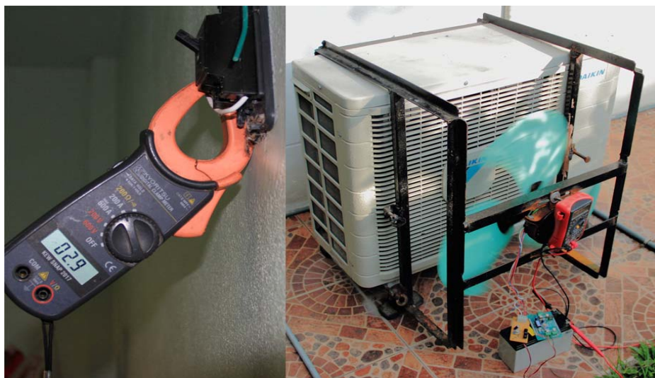
รูปที่ 4.6 ปริมาณการใช้กระแสไฟฟ้าของคอมเพรสเซอร์แอร์ขณะต่อกับกังหันลม
