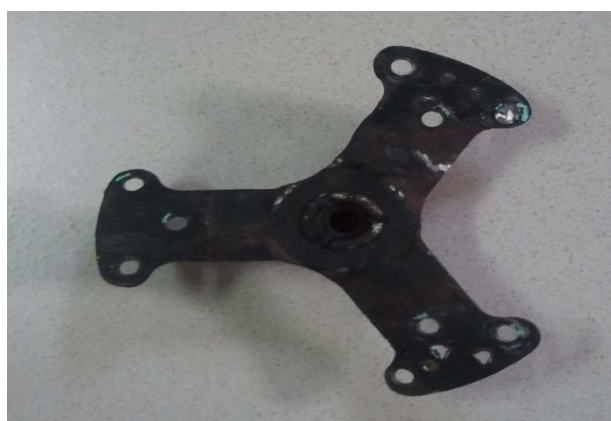
รูปที่ 3.13 ดุมใบพัดที่ได้จากใบพัดลมเก่า
