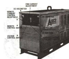
เครื่องเชื่อมที่ใช้เครื่องยนต์ขับ ขนาด 400 แอมแปร์กระแสตรง
