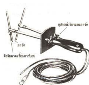
รูปที่ 2.30 แสดงภาพคีมจับลวดเชื่อมคาร์บอนคู่
