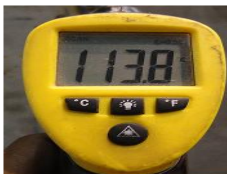
รูปที่ 3.12 แสดงภาพการวัดอุณหภูมิในการทดสอบงานเชื่อม
