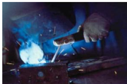
รูปที่ 2.1 แสดงภาพการหลอมเหลวของชิ้นงานกับลวดเชื่อมเมื่อเกิดการอาร์คในขณะที่เชื่อม
