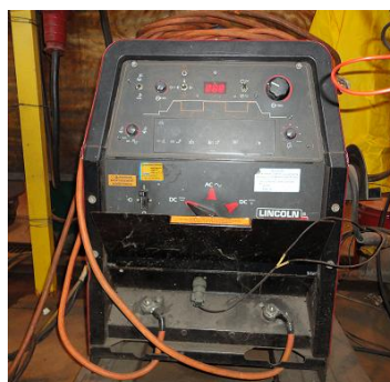
รูปที่ 3.3 แสดงภาพเครื่องเชื่อมหม้อแปลงเรกติไฟเออร์กระแสตรงพร้อมใช้งานในการทดสอบ
