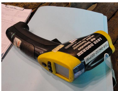
รูปที่ 3.8 แสดงภาพเทอร์โมมิเตอร์สำหรับใช้วัดควบคุมอุณหภูมิในการทดสอบงานเชื่อม
