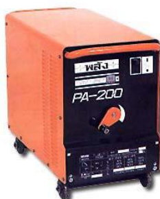
รูปที่ 2.27 แสดงภาพเครื่องเชื่อมกระแสสลับ – กระแสดรงแบบหม้อแปลงเรกติไฟเออร์
