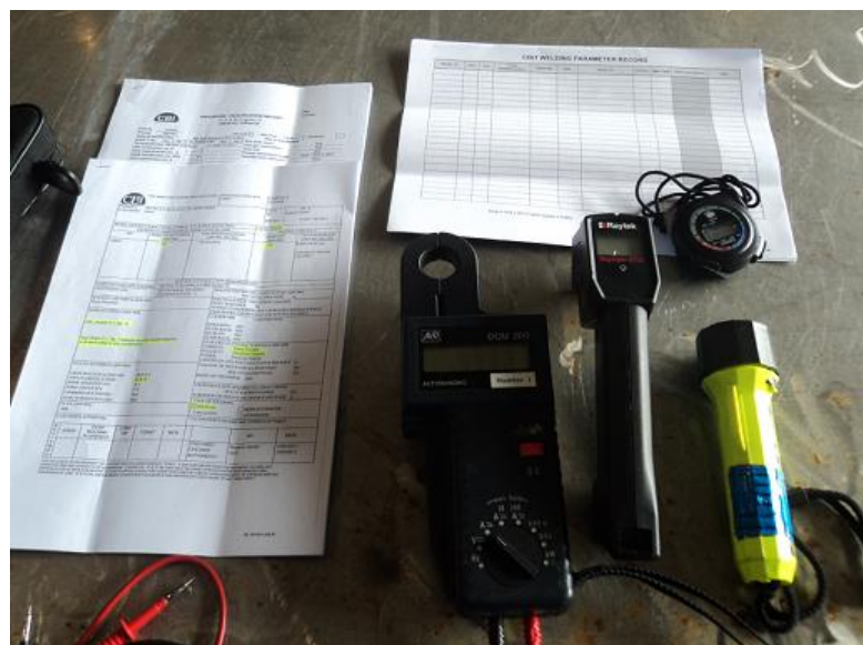
รูปที่ ก 2 แสดงภาพอุปกรณ์ที่ใช้ในการควบคุมพารามิเตอร์ของเครื่องเชื่อมไฟฟ้า
