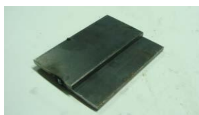
รูปที่ 2.5 แสดงภาพการต่อชิ้นงานแบบเกย
