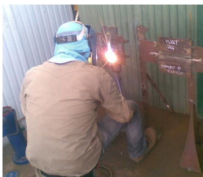
รูปที่ 3.6 แสดงภาพการทดสอบการเชื่อมแผ่นโลหะโดยช่างเชื่อมฝีมือที่เข้าทำการทดสอบ
