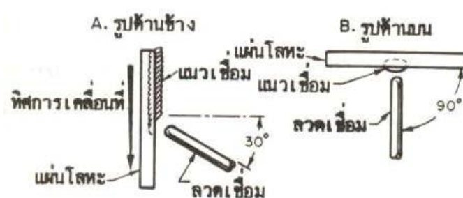
รูปที่ 2.52 แสดงภาพตำแหน่งลวดเชื่อมเมื่อเชื่อมแนวเชื่อมเส้นขนานทำดัดเคลื่อนลง
