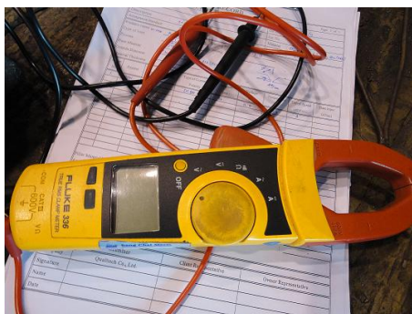
รูปที่ 3.7 แสดงภาพคลิปแอมมิเตอร์สำหรับใช้วัดควบคุมกระแสไฟฟ้าในการทดสอบงานเชื่อม
