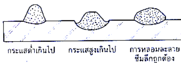
รูปที่ 2.37 แสดงภาพการเปรียบเทียบความแตกต่างของแนวเชื่อมเมื่อกระแสไฟต่างกัน
