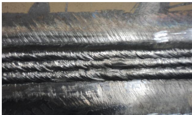
รูปที่ ก 7 แสดงภาพการตรวจสอบความสมบูรณ์ของชิ้นงานเชื่อมด้วยสายตา
