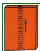
ท่าตั้งขึ้น (PF Vertical Upwards)
