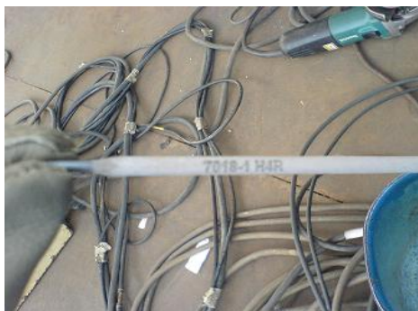
รูปที่ 3.4 แสดงภาพลวดเชื่อมไฟฟ้าที่ใช้ในการทดสอบงานเชื่อมตาม WPS
