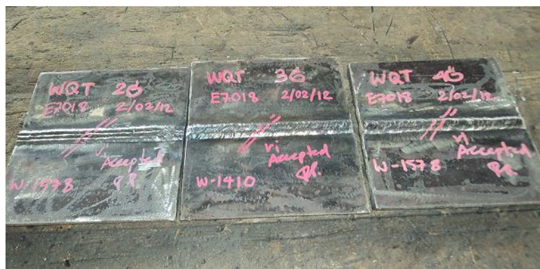
รูปที่ ก 8 แสดงภาพชิ้นงานทดสอบสำเร็จและผ่านการตรวจสอบ
