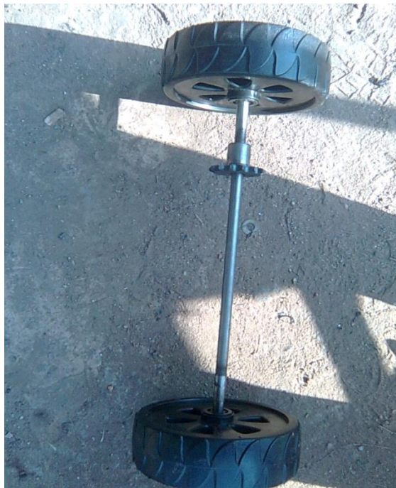
รูปที่ ก 6 แสดงรูปเพลาลับเคลื่อน
