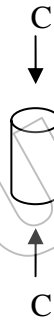
รูปที่ 3.14 การทดสอบหาค่าลึงอัดของคอนกรีต
