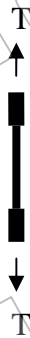
รูปที่ 3.11 การทดสอบหาลังรับแรงดึงของไม้ไฟ
