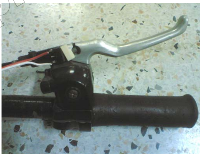
รูปที่ 3.43 การต่อลิมิตสวิตช์เข้ากับเบรกมือ
