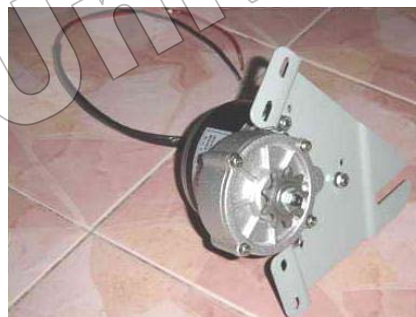
รูปที่ 3.48 มอเตอร์ขนาด 250W 24V อัตราทดรอบ 1:6 4125RPM
